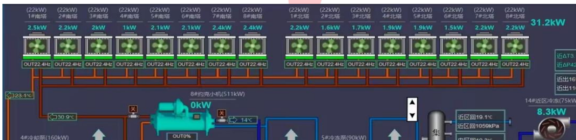
图 5 冷却塔大温差、变流量、小冷幅、宽频、低耗运行
