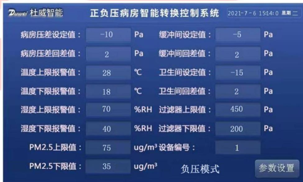
图 6 正负压病房智能转换控制系统设置
